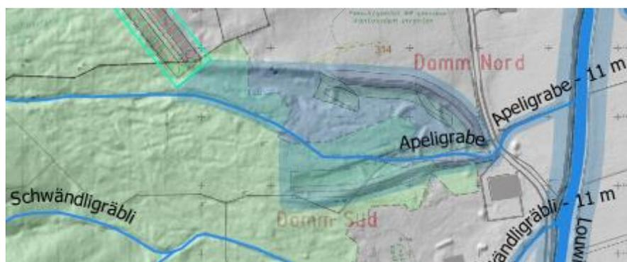
Abbildung 11: Apeligrabe mit Damm Nord und Damm Süd (Plan Schutzdämme Apeligrabe und digitales Terrainmodell des Kantons Bern überlagert mit Zonenplan Gewässerraum 1) sowie dem Gewässerraum, der die Dämme sowie Korridore von mindestens 5 m ab luftseitigem Dammfuss zur Sicherung der Zugänglichkeit umfasst.
