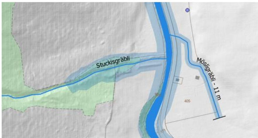
Abbildung 13: Stuckisgräbli mit beidseitigen Dämmen (digitales Terrainmodell des Kantons Bern überlagert mit Zonenplan Gewässerraum 1). Gewässerraum mit Korridoren von mind. 5 m ab luftseitigem Dammfuss zwecks Sicherung der Zugänglichkeit.
